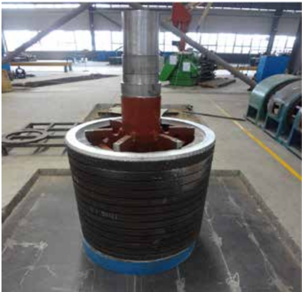
● 河北衡丰发电有磨煤机YTM630-6 1250KW转子重铸
