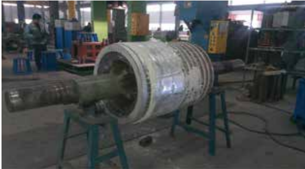
● 河北衡丰发电有磨煤机YTM630-6 1250KW转子重铸
