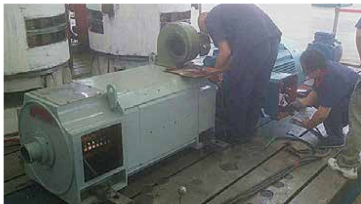
● 直流电机负载对托试验
