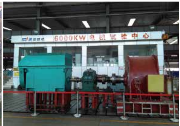
● 永磁同步电机负载试验
