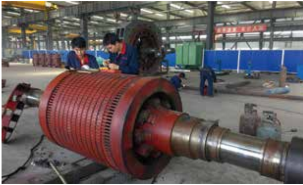
● 唐山某钢铁厂8000KW电机端环处理
