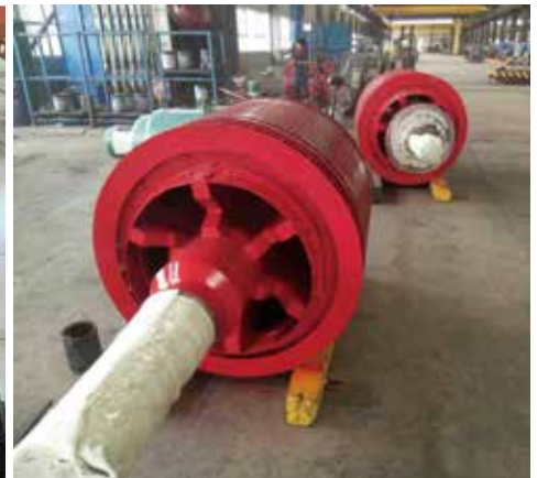
● 河北建投任丘电厂YKSL 1950-12/1500-1950KW循环水杯电机端环加固、导条焊接
