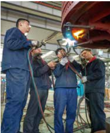
● 河北建投任丘电厂YKSL 1950-12/1500-1950KW循环水杯电机端环加固、导条焊接
