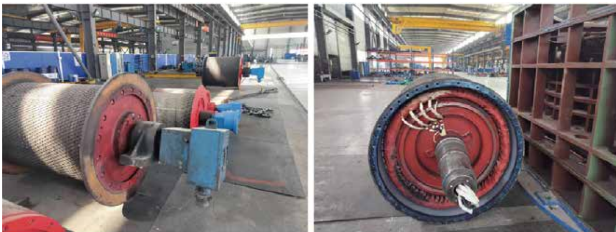
煤矿行业-永磁滚筒维修
